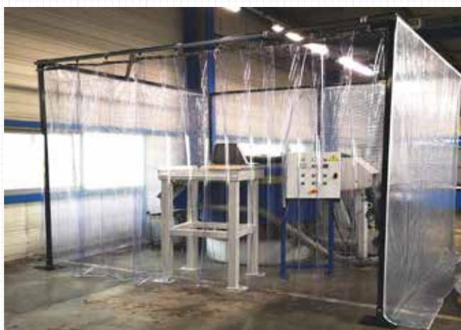
Produit : Isolation d'une machine de polissage.
