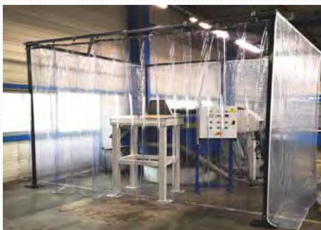
Produit : Isolation d'une machine de polissage.
