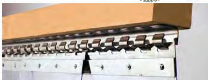
■ **Suspension « Croch'lanières »** : Simple à poser, elle permet, par rapport à la « CC » un décrochage facile des lanières. Cette solution est aussi à privilégier pour les passages intensifs car le basculement est assuré par les pièces métalliques et non pas par les lanières. Elle est réalisée en acier galvanisé (CA) ou en inox (CX).
