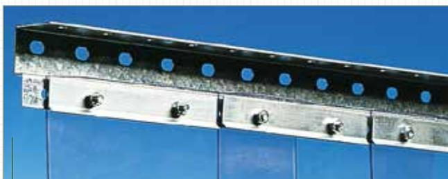
■ **Suspension « CC »** : elle se compose d'un solide profilé en acier galvanisé perforé, de contre-plaques et de boulons qui traversent et pincent les lanières.
