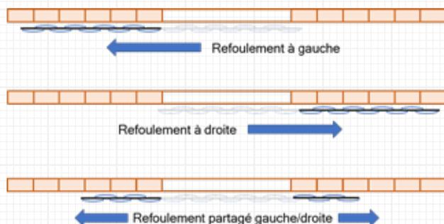
« **Coulissant parallèle** » : Ce système est compatible avec tous les types de lanières et de suspensions. Il permet de dégager le passage en faisant glisser la porte sur le côté (droit ou gauche indifféremment). Cela suppose que la place soit disponible. Sinon, il est possible de partager la porte en deux pour en faire coulisser une partie d'un côté et l'autre de l'autre. L'ensemble du dispositif de coulissement est disponible en acier galvanisé ou INOX 304.
